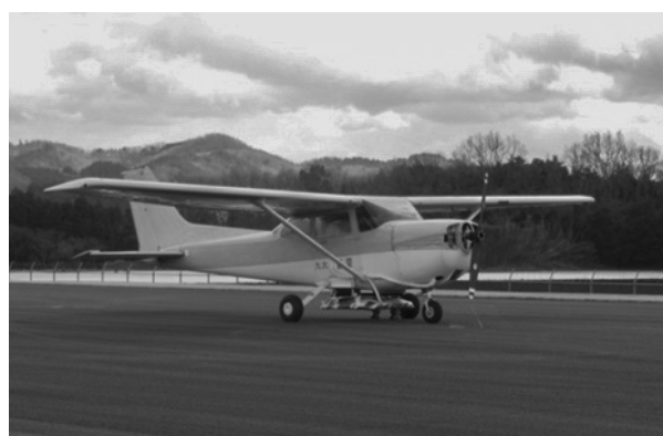
図1 電気モーターに換装したセスナ機の地上走行試験の様子
