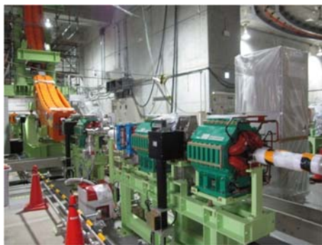
重粒子線を垂直、斜め45度から照射するラインは、円周部分を出た後、建物の3階に引き上げられる。
