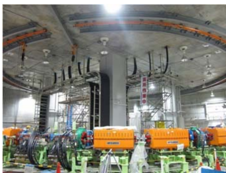
重粒子線を作り出すシンクロトロン。 大きさは直径20メートル
